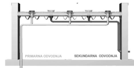
Slika 3: Primjer spajanja primare i sekundarne odvodnje
